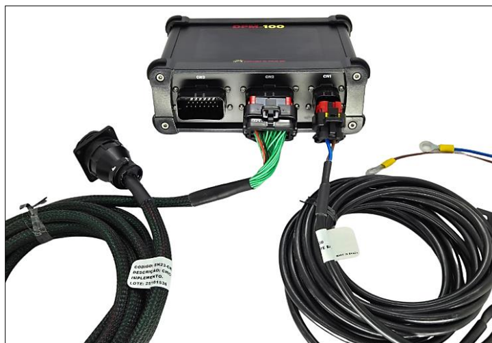
Figura 09 – Chicotes conectados ao DPM-100. Chicote Cabine/Trator (à esquerda: CN2) e Chicote de Alimentação (à direita: CN1)
